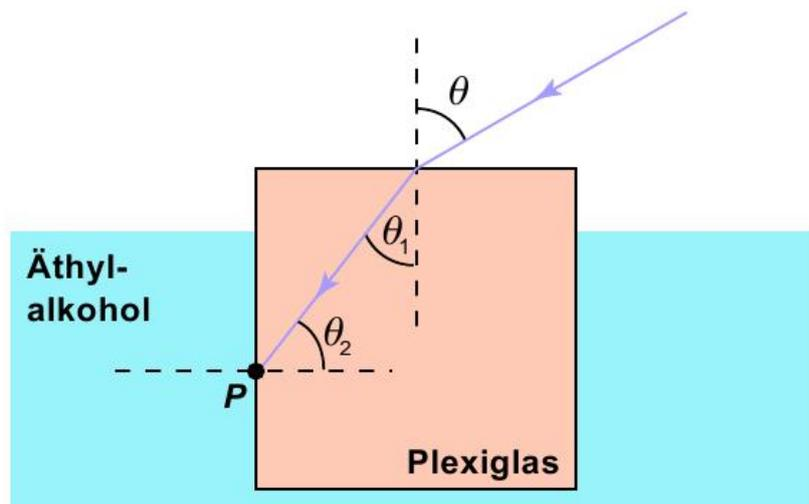
Für die erste Brechung gilt nach dem Brechungsgesetz  $\sin\theta = n_{\text{Plexiglas}}\sin\theta_1$ . Am Punkt P folgt aus der Symmetrie der Anordnung, dass  $\theta_2 = 90^\circ - \theta_1$ . Das Brechungsgesetz lautet hier:
