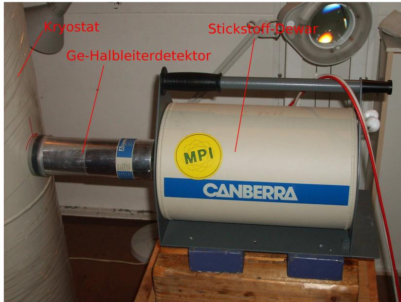
Abbildung 4.6: Foto des Ge-Halbleiterdetektors, der für die Thermometerkalibrierung verwendet wurde. Der Ge-Kristall ( $\varnothing$  50,5 mm, Läng 49,5 mm) befindet sich in dem silbernen Zylinder auf der linken Seite. Rechts davon ist der Stickstoffdewar zur Kühlung des Ge-Kristalls zu sehen. Dieser Ge-Detektor hat bei 1332,5 keV eine Energieauflösung von  $\Delta E_{FWHM} = 1,77$  keV und bei 122 keV eine Auflösung von  $\Delta E_{FWHM} = 0,88$  keV.
