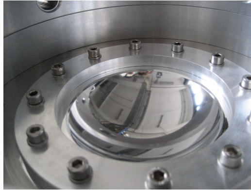
Abbildung 3.13: Die eingebaute und unter Drucklast stehende, eingewölbte Mylarfolie. Mit einem Aluminiumring wird die Folie am Kreuzstück befestigt und trennt das gasgefüllte Detektorvolumen vom evakuierten Strahlrohr.
