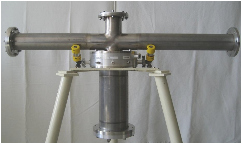
Abbildung 3.5: Der Detektor als Ganzes: Zu erkennen ist das 1 m lange Strahlrohr, in dessen Kreuzstück von oben die Halterung am Targetflansch eingesetzt ist. Unten an diesem hängt die Detektoreinheit mit Vieldrahtkammer, Szintillator und Photomultiplier. Durch die beiden Nadelventile an den Seiten des gasgefüllten Topfes kann der Gasdruck auch im Durchfluss konstant gehalten werden. Ein weiterer KF-Flansch für ein Manometer und die Durchführungen für Hochspannung und Signal der Kammer sind ebenfalls zu erkennen. Nicht zu sehen, da auf der anderen Seite positioniert, ist der KF-Flansch zum Abpumpen des Strahlrohres.
