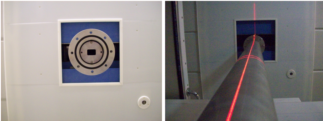
Abbildung 3.16: Links: Blick von der medizinischen Station auf die Trennwand zum Nectar-Strahlplatz, hinter der das Experiment aufgebaut war. Man erkennt einen der 30 cm langen Eisenkollimatoren, der in das Strahlrohr eingeführt wurde. Rechts: Mittels eines Laservisiers konnten die Rohre und die Kollimatoren in diesen auf die genaue Strahlposition eingestellt werden.
