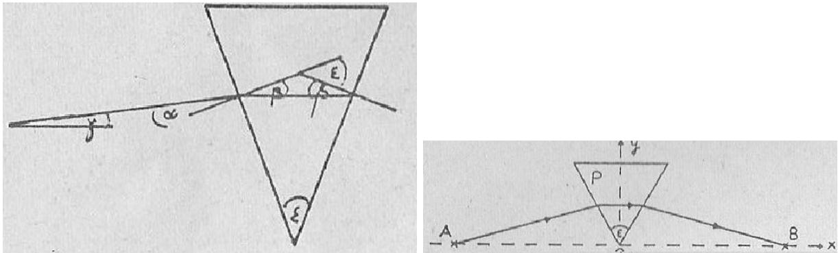
Wegen des symmetrischen Strahlenganges erhalten wir  $2\beta = \epsilon$ . Die Ablenkung  $\delta$  des Strahls beträgt:
