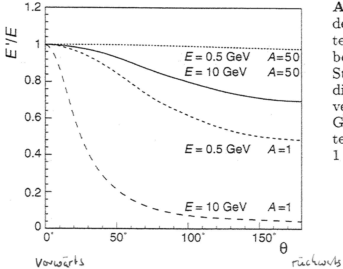
**Abb. 5.2.** Winkelabhängigkeit der auf die Strahlenergie normierten Elektronstreuenergie  $E'/E$  bei elastischer Elektron-Kern-Streuung. Die Kurven zeigen diesen Zusammenhang für zwei verschiedene Strahlenergien (0.5 GeV und 10 GeV) und zwei unterschiedlich schwere Kerne ( $A = 1$  und  $A = 50$ ).
