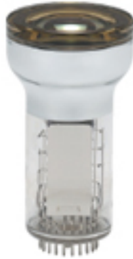
Abbildung 3.26: Bild des 3-Zoll-PMTs R6091 von Hamamatsu [22]
