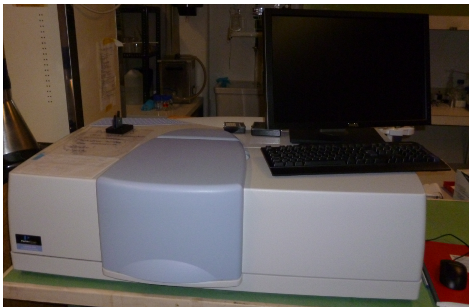
Abbildung 4.2: Bild des Spektrometers Lambda 850 von Perkin Elmer: Über den angeschlossenen Rechner werden die Daten ausgelesen.
