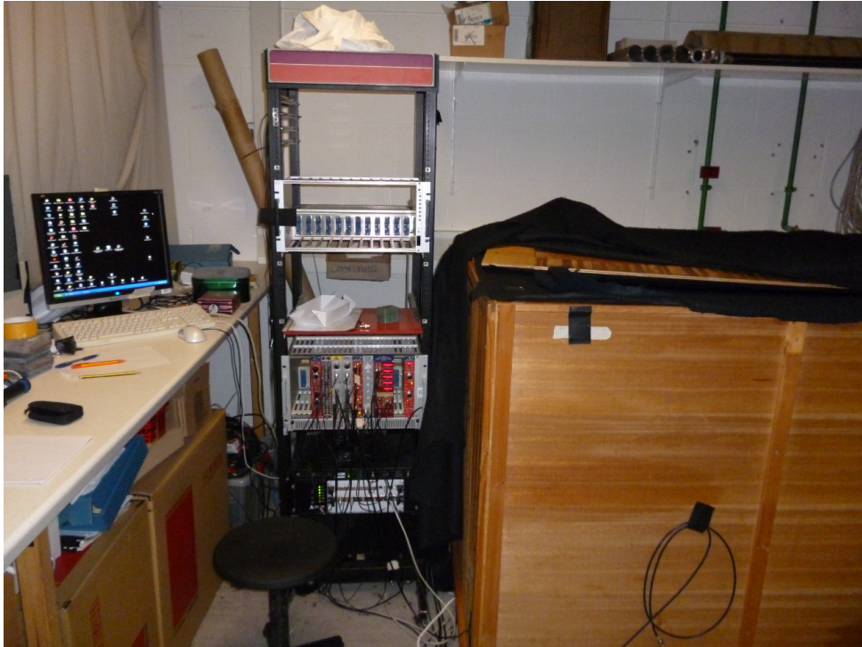
Abbildung 3.1: Bild des Photosensor-Teststandes: Rechts ist die Black-Box zu sehen, in der Mitte die Elektronik.
