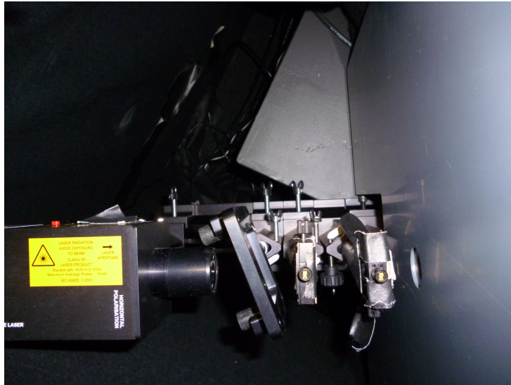
Abbildung 3.16: Bild der eingebauten Optik: Hier sieht man ganz links den Laser, rechts davon der Filterhalter, danach die beiden Positionierer, in denen die Linsen befestigt sind, ganz rechts ist noch die variable Blende zu sehen. Am rechten Positionierer sieht man die mitgelieferte Daumenschraube, alle anderen wurden bereits durch Flügelschrauben ersetzt.
