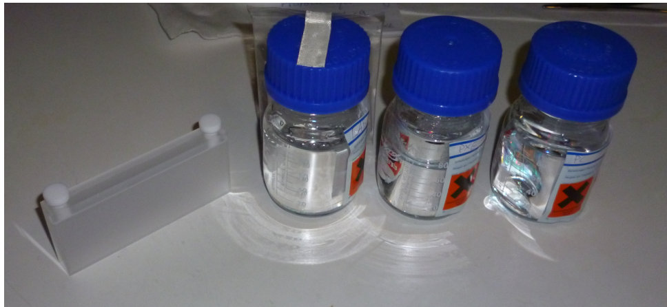
Abbildung 4.1: Bild der Gläser mit Szintillator und der Küvette: In den Gläsern sind Teile der Reflexionsfolie in den verschiedenen Szintillatorflüssigkeiten eingelegt. Links ist die verwendete Küvette zu sehen.
