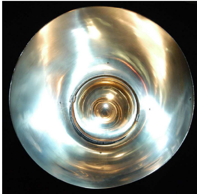
Abbildung 2.4: Bild eines Lichtkonzentrators bei Borexino [14]
