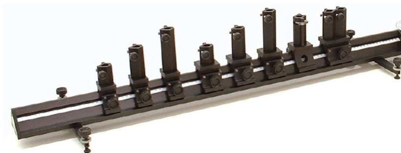
Abbildung 3.3: Bild einer optischen Bank der Firma Henschke mit verschiedenen Reitern [18]
